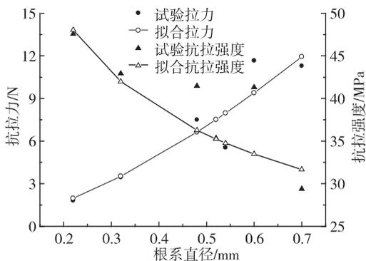
图 3 芦竹根系直径与抗拉力、抗拉强度关系曲线
