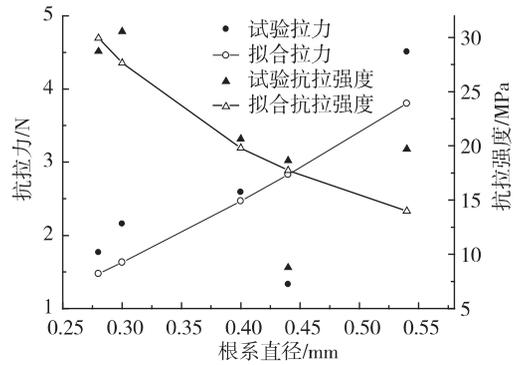
图 4 狗牙根根系直径与抗拉力、抗拉强度关系曲线
