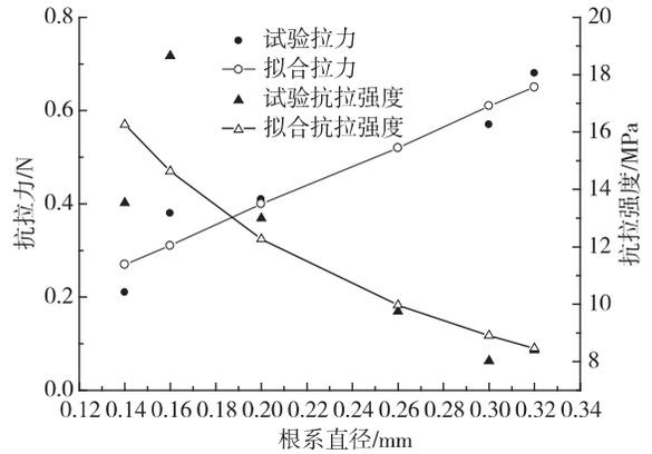
图 5 早熟禾根系直径与抗拉力、抗拉强度关系曲线
