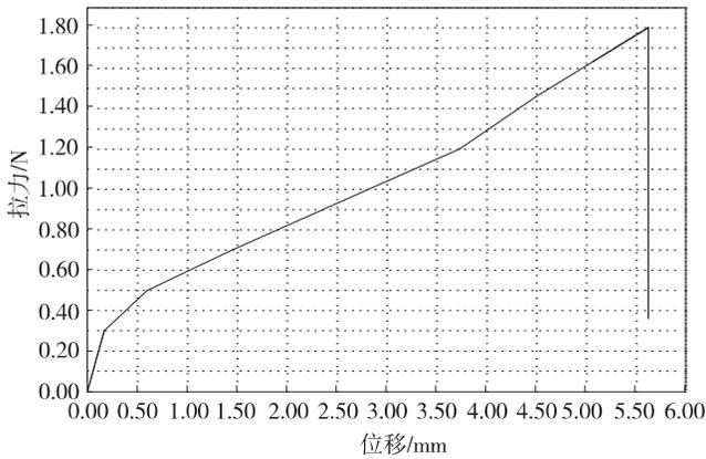
图 2 芦竹根系直径为 0.22 mm 时的拉力-位移关系曲线
