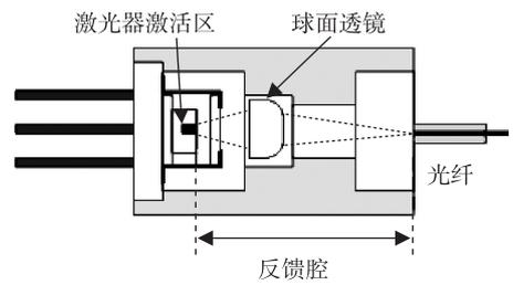
图 1 新型单模法布里-珀罗激光器结构简图
