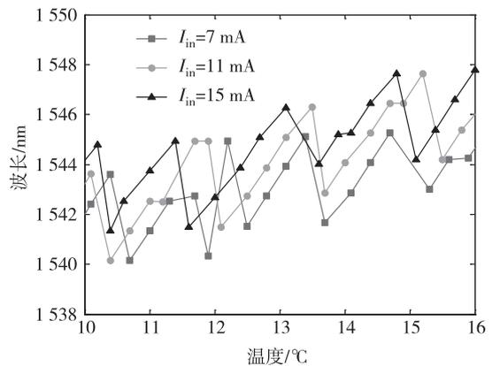
图 3 控制模峰值波长随温度的变化
