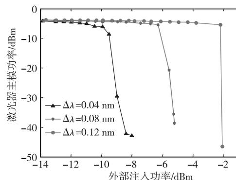
图 6 在不同的波长失谐下,激光器主模功率随外部注入功率的变化
