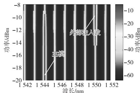
图 8 激光模随外部注入功率的演变过程
