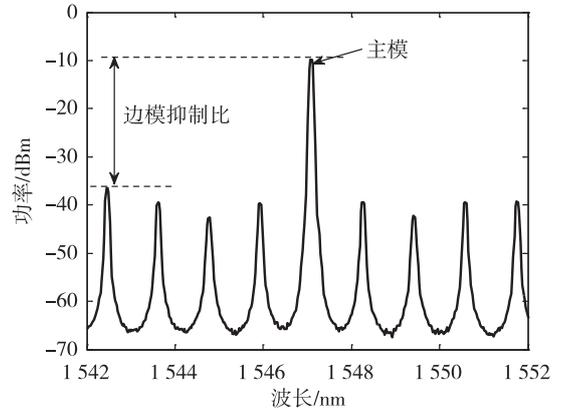
图 2 单模激光器输出激光谱
