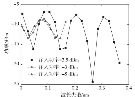
图 4 输出的外部注入锁定模功率在不同的注入功率下随波长失谐的变化
