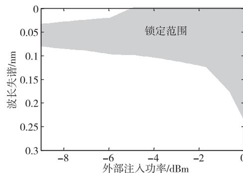
图 7 注入锁定的波长失谐范围随外部注入功率的变化
