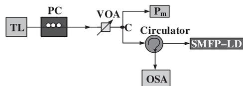
注:图中 TL 为可调谐激光器、PC 为偏振控制器、VOA 为可变衰减器、C 为光纤耦合器、Pm 为功率检测计、Circulator 为环形器、SMFP-LD 为单模法布里-珀罗激光器和 OSA 光谱分析仪。
