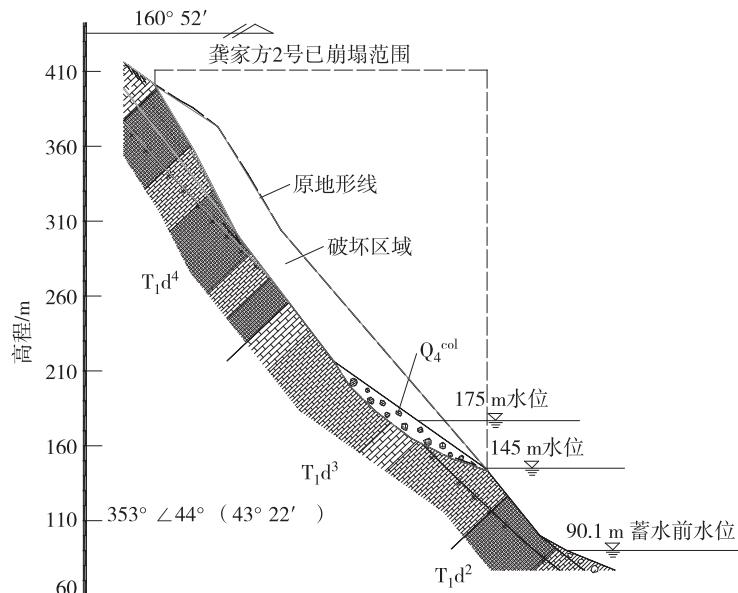
图 3 龚家方 2 号斜坡滑塌后地质剖面图
