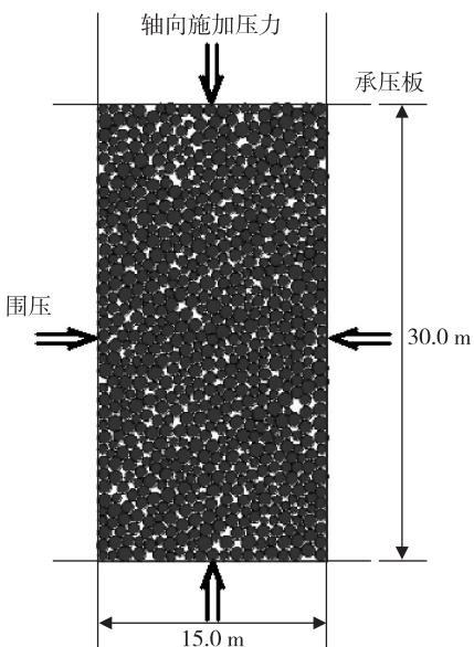
图 4 双轴颗粒流试验模型
