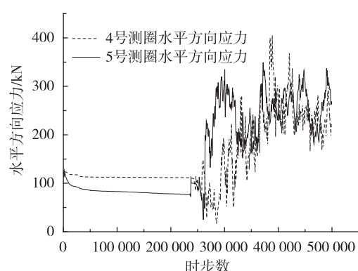
图9  $5 \times 10^5$  时步内各测量圆水平方向应力变化曲线
