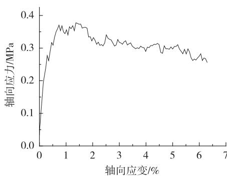
a 崩坡积层(50 kPa围压)
