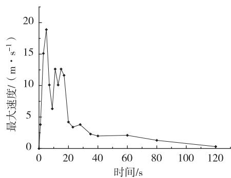
图 12 不同时刻斜坡运动最大速度变化曲线
