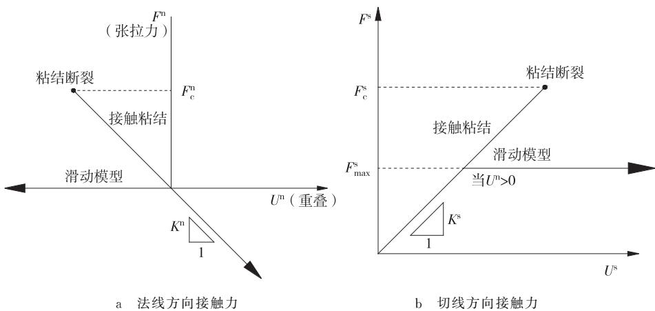
图1 点接触粘结本构行为的图解分析
