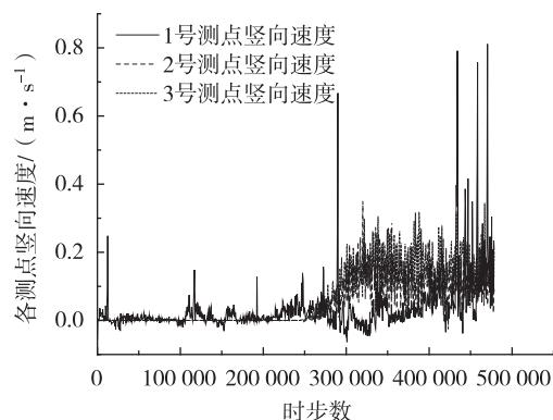
图8  $5 \times 10^5$  时步内各测点竖向速度的变化
