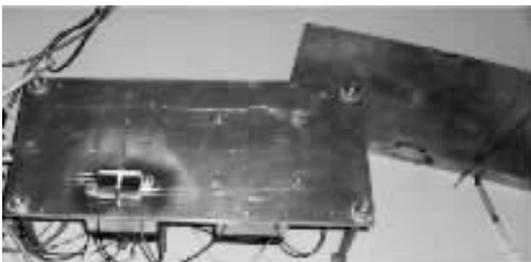
图3 光纤激光器散热装置
