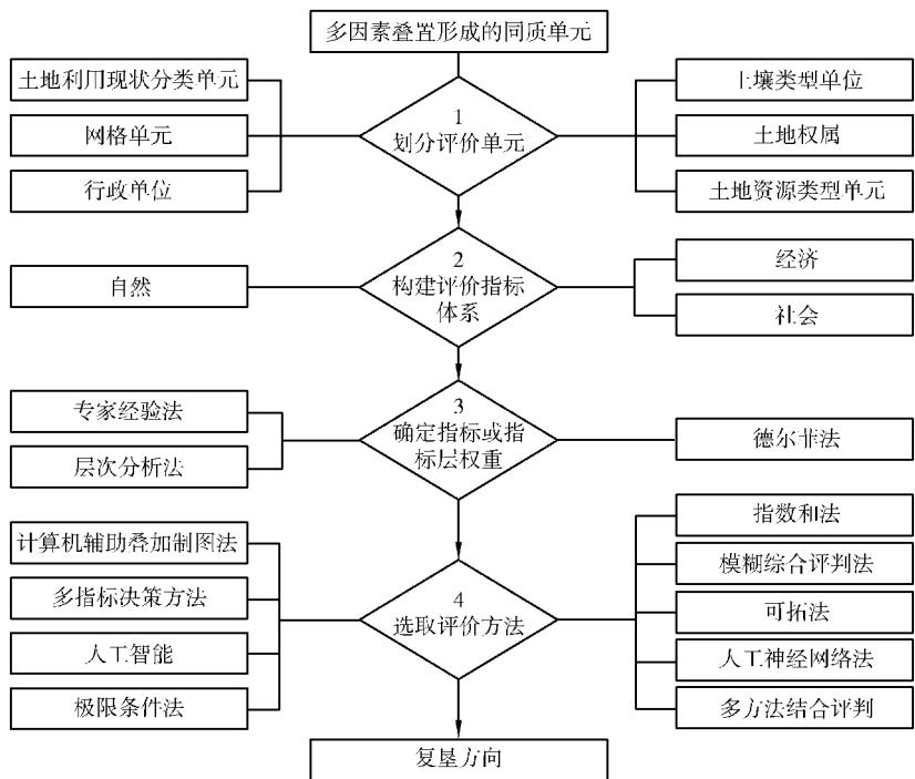
图3 煤矿区土地复垦方向确定流程图
