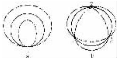
图2 圆形封闭弦端点固定时形成的驻波示意图
